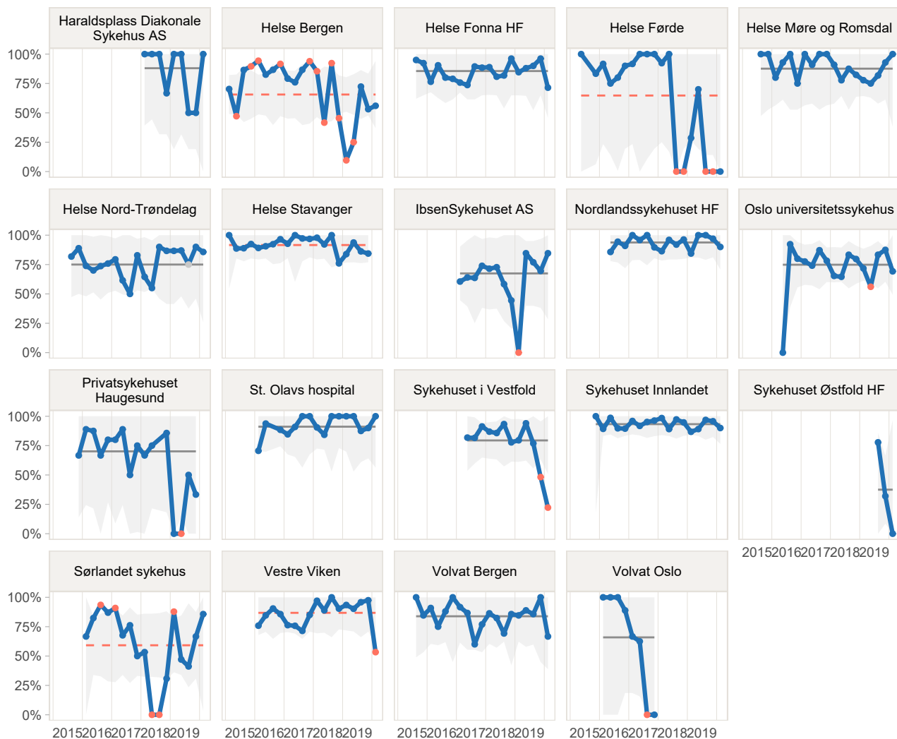
FIGUR 3.3: P-diagram over eittårs oppfølgingsgrad innan normtid, delt inn etter sjukehus og tid (kvartal). Dei grå felta indikerer styringsgrenser etter SPC-metodikken (3 sigma-grenser), altså området for normalvariasjon. Viss enkeltverdiar fell utanfor grensene (markert som oransje punkt) og/eller midtlinja er oransje, viser dette at oppfølgingsgraden ikkje har vore stabil over tid. Tidsaksen viser operasjonstidspunktet. Basert på data frå 7 705 primær-/revisjonsoperasjonar. Volvat Oslo slutta med fedmeoperasjonar i 2017.
